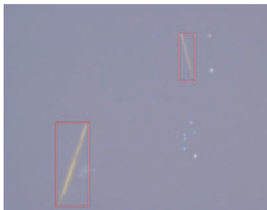
アスベスト検出の例
